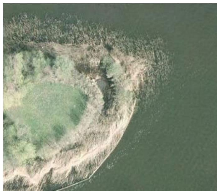
figuur 2.3 Identieke locatie gefotografeerd vanuit de lucht. Het riet is veel beter ontwikkeld op de plek waar de beschoeiing ontbreekt. Ook zie je daar mooi de uitloopzone.
